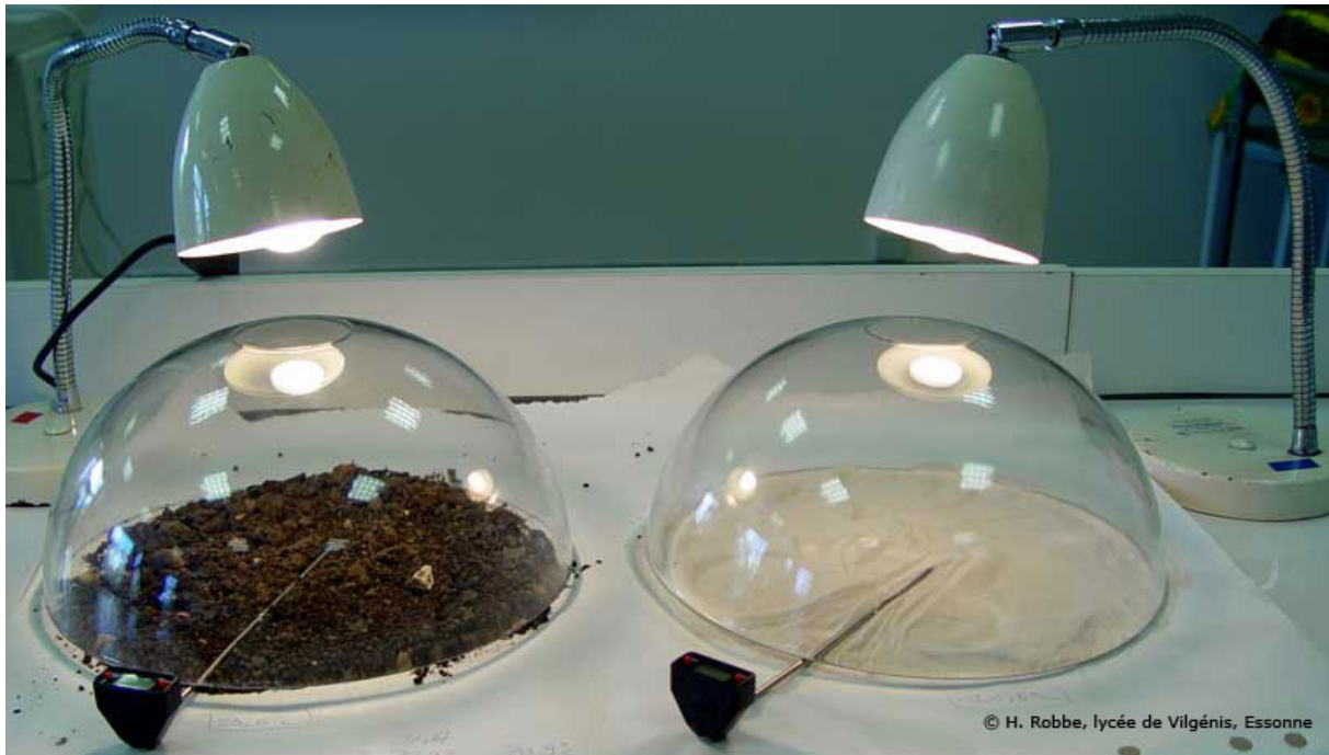
Modèle expérimental : sous un saladier est disposé de la terre noire, sous un autre, du sable clair.
