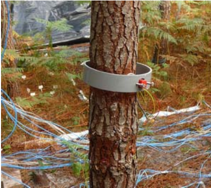
Microdendromètres (potentiomètres linéaires) – mesurer la croissance en diamètre du tronc
