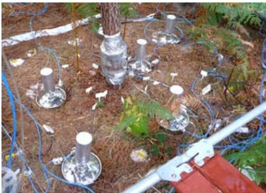
Chambres pour mesurer la respiration du sol et des racines
