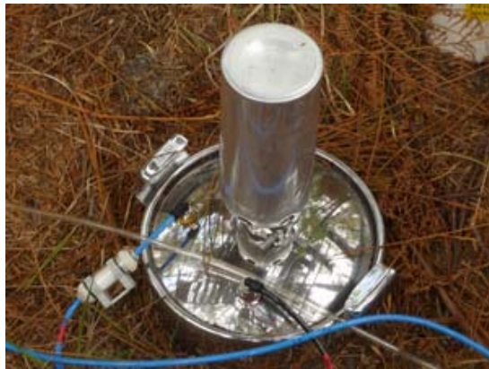
Chambres pour mesurer la respiration du sol et des racines
