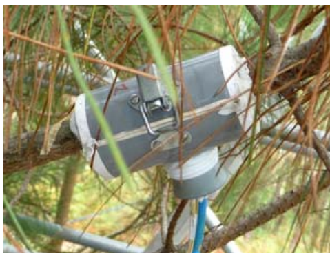
Chambres pour mesurer la respiration du tronc et des branches
