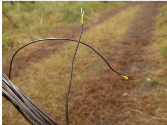
Thermocouples – mesurer la température du tronc
